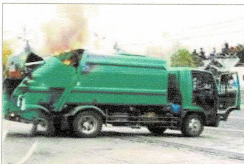
荷箱内でリチウムイオン蓄電池が圧し潰されて出火
